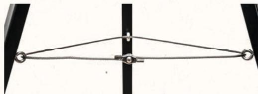
3. Drahtseil durch Ösen fädeln und mit Drahtseilklemme verbinden, Drahtseilklemme mit Schlüssel (7mm) fest anziehen.
