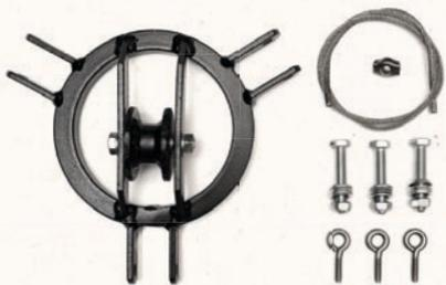
1. (3x) Beine mit Schrauben an Umlenkrolle anbringen - Muttern mit Schlüssel (13mm) fest anziehen, bis zu einem spürbaren Widerstand beim Verändern des Winkels der Standbeine.
