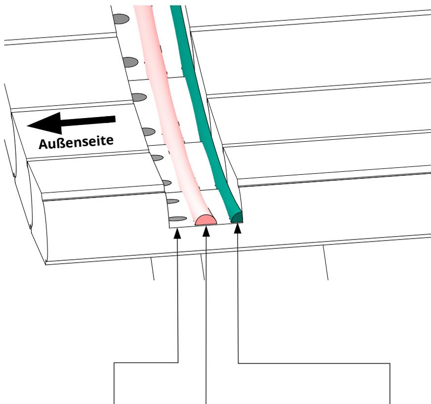
3. Gummidichtung mittig in Fräsung platzieren
