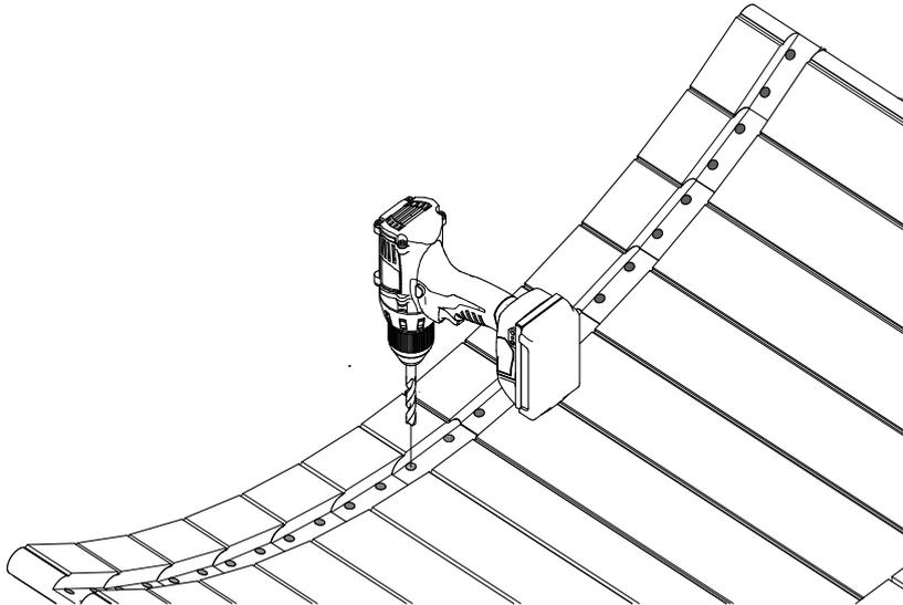
1. 2x 12mm Bohrer verwenden und in **alle** unteren Bohlen bohren (die mit Sockelauflage)
