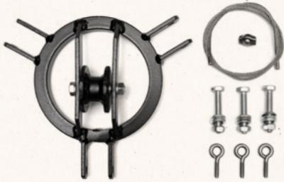
1. (3x) Beine mit Schrauben an Umlenkrolle anbringen - Muttern mit Schlüssel (13mm) fest anziehen, bis zu einem spürbaren Widerstand beim Verändern des Winkels der Standbeine. Je vier Unterlegscheiben pro Bein verwenden.
